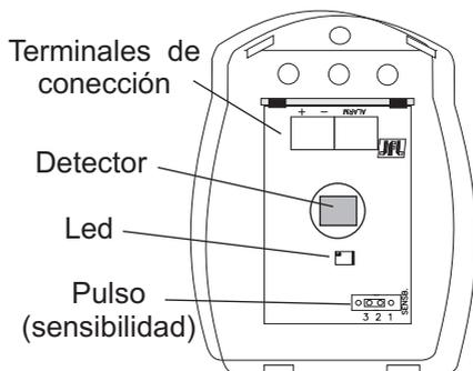
**Terminales de conexión - Alimentación del sensor.**
