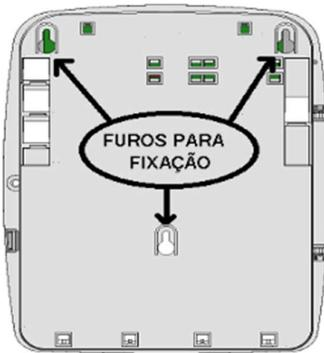
El dibujo de al lado muestra los orificios de fijación. Deben utilizarse para la instalación del electrificador.
